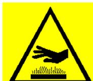
Las paredes externas de la máquina pueden llegar a temperaturas elevadas durante el funcionamiento.
