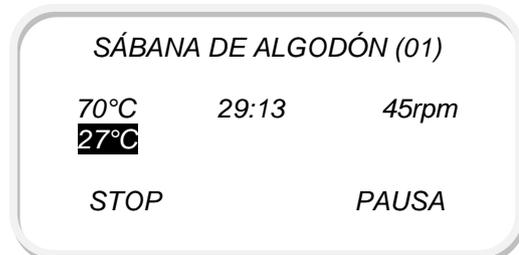
La parte final de un ciclo sucede sin calor (fase de enfriamiento) para asegurarse que los artículos sean puestos a una temperatura que garantice que no sean estropeados.
